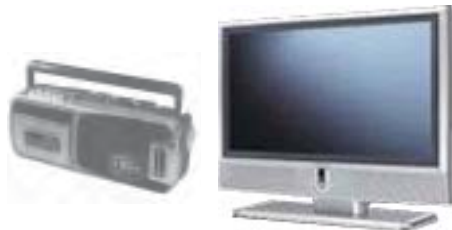
Gambar 9.11 Peralatan yang mengubah energi listrik menjadi energi bunyi
